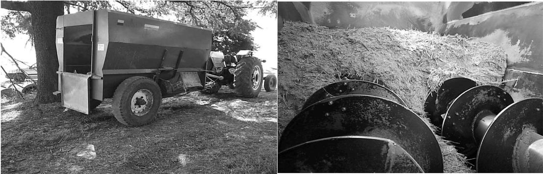
*Mixer de dos sinfines con cuchillas, exterior e interior*
