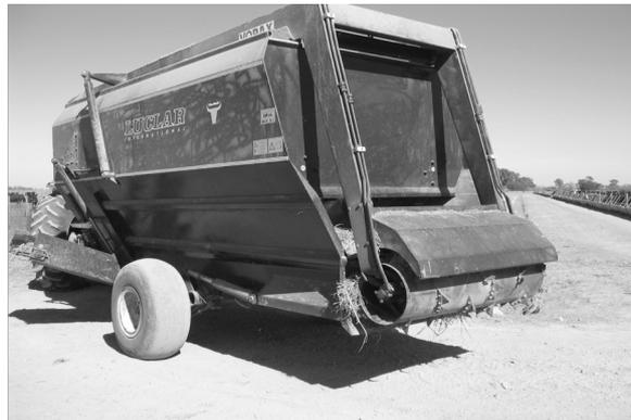
*Mixer de dos sinfines con cuchillas y fresa*
